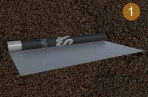
1 Контактная мембрана MasterSeal 754, обеспечивающая сплошную адгезию с бетонными конструкциями, разработана на основе технологии ламинирования FPO-мембраны нетканым флисом.
