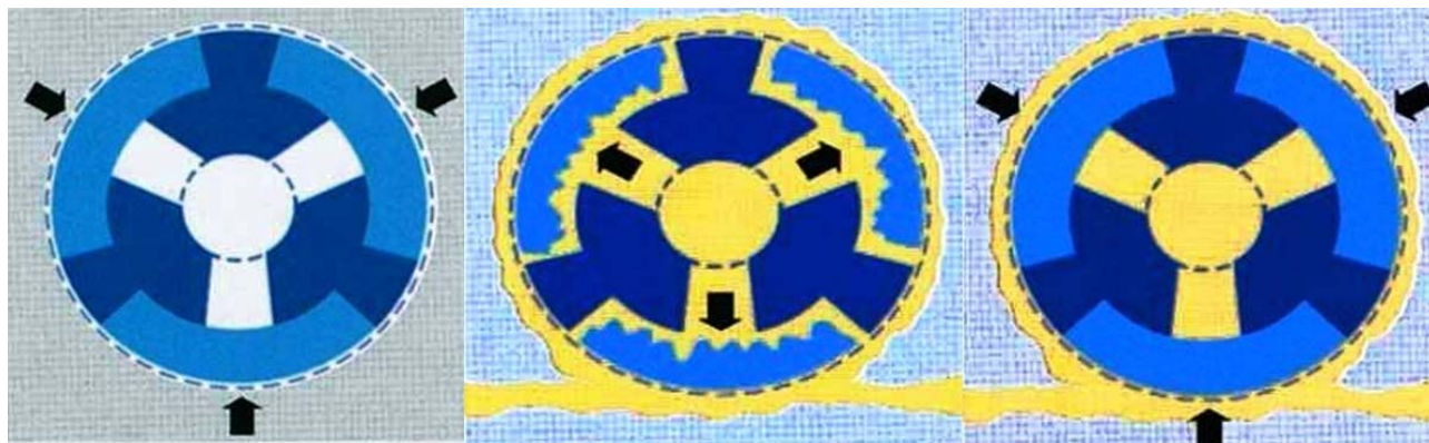
ОБЖАТИЕ БЕТОННОЙ СМЕСЬЮ – КЛАПАНЫ ЗАКРЫТЫ
